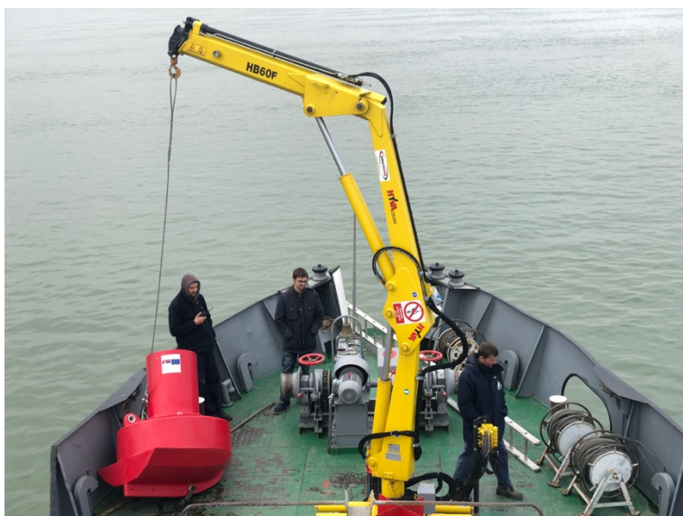
Obrázok 71. Manipulácia s plastovou bójou na vytyčovacej lodi. Bója je zatiaľ bez AIS modulu
