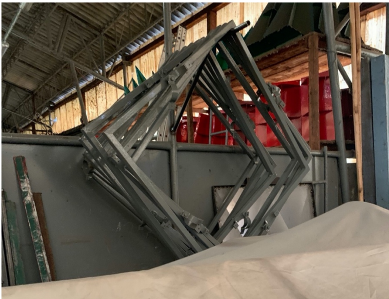
Obrázok 40. Rámy pobrežných znakov v dielni
