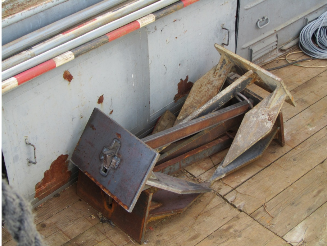
Obrázok 34. Oceľová kotva používaná v SVP, š. p.
