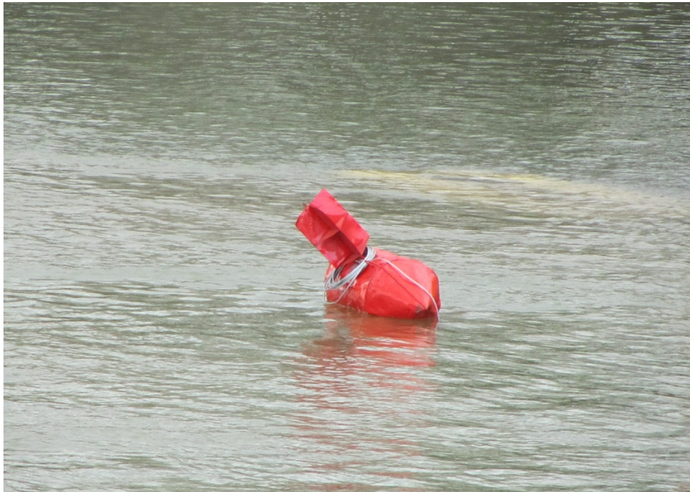
Obrázok 39. Bója v pokojnej vode so zaťaženie (cca 5kg) umiestneným pod radarovým odražačom
