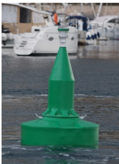
Obrázok 48. B7 Bója pre vnútrozemské vodné cesty, GBR-1250 (Gisman), NAV02 (JFC Marine)
