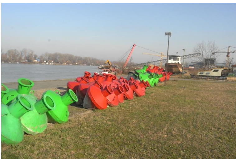
Obrázok 69. Srbské kovové bóje pripravené na montáž svietidla s komunikačným modulom AIS
