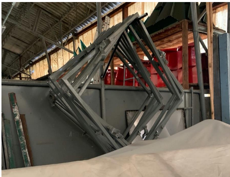
Obrázok 40. Rámy pobrežných znakov v dielni
