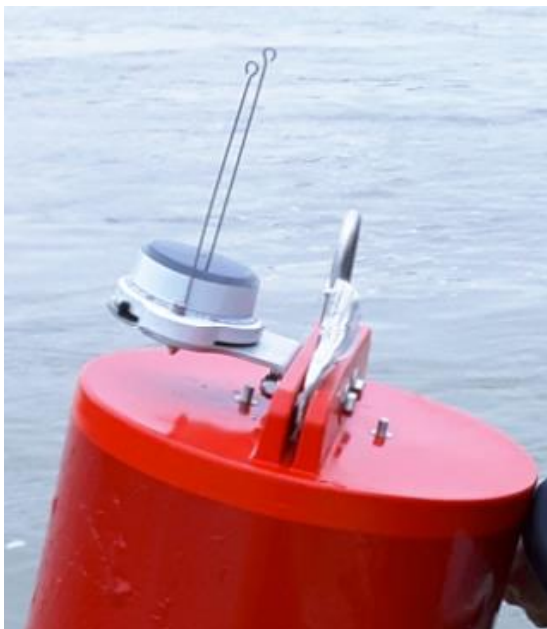
Obrázok 59. Syntetický monitorovaný AIS AtoN
