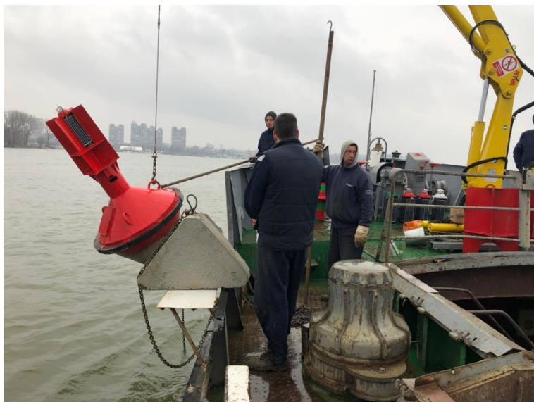
Obrázok 70. Manipulácia s kovovou bójou vybavenou AIS modulom na vytyčovacej lodi.
