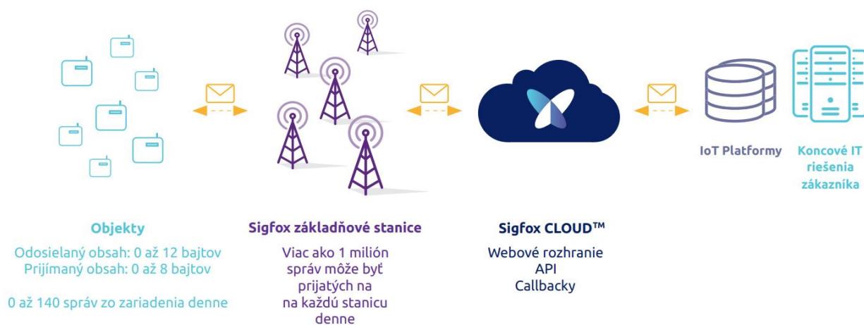
Obrázok 51. Komunikačná schéma SigFox
