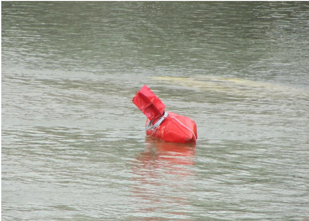
Obrázok 39. Bója v pokojnej vode so zaťaženie (cca 5kg) umiestneným pod radarovým odrážačom
