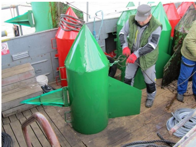
Obrázok 38. Výmena bóje bez svetidla za renovovanú a natretú bóju
