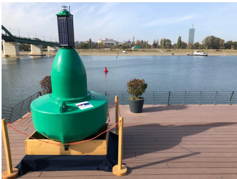
Obrázok 68. Srbská plastová bója vybavená svietidlom a komunikačným modulom AIS
