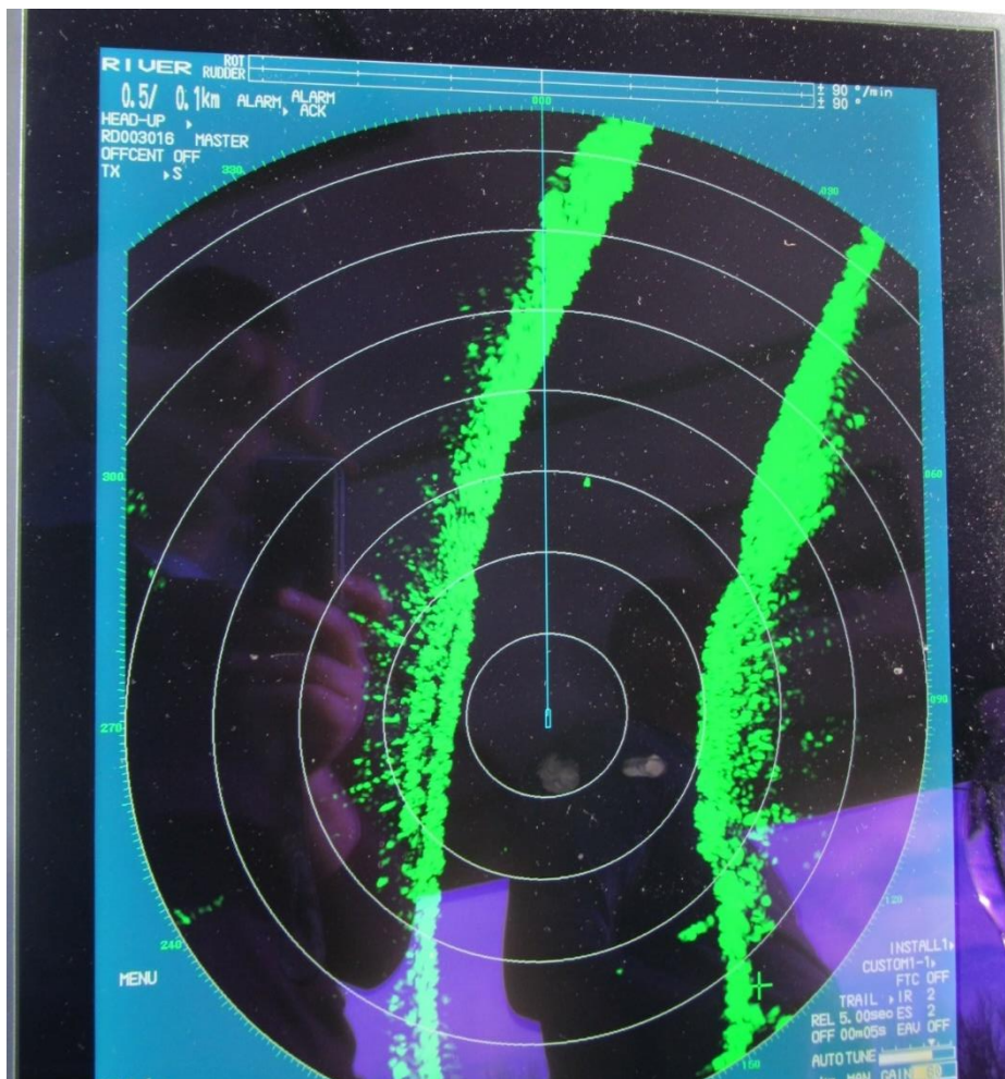
Obrázok 37. Radarový odraz bóje bez svetidla (proti prúdu a po prúde z polohy lode)
