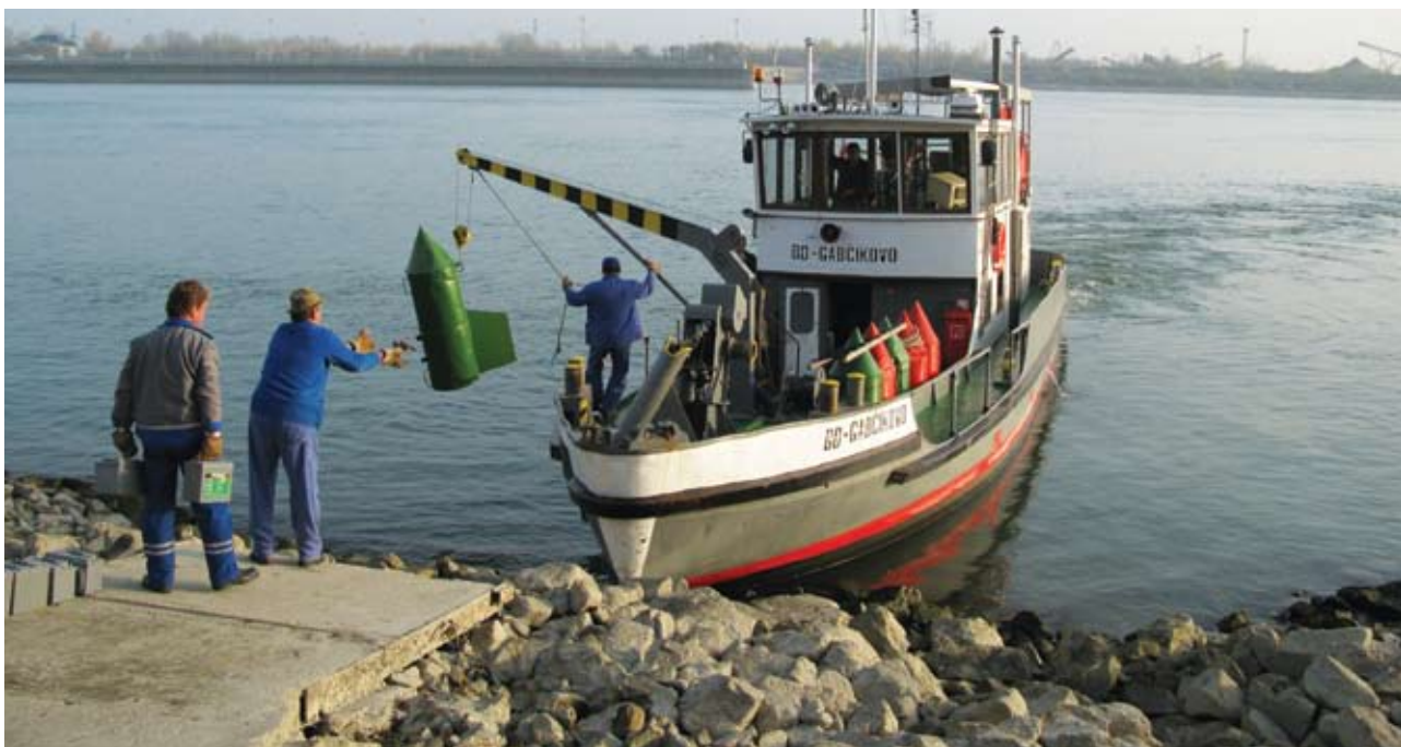
Zabezpečovanie plavebných podmienok - vytyčovanie plavebnej dráhy
