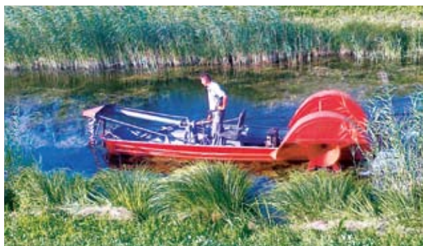
Kosba vodného rastlínstva plávajúcou kosačkou v ľavom priesakovom kanáli v Gabčíkove
