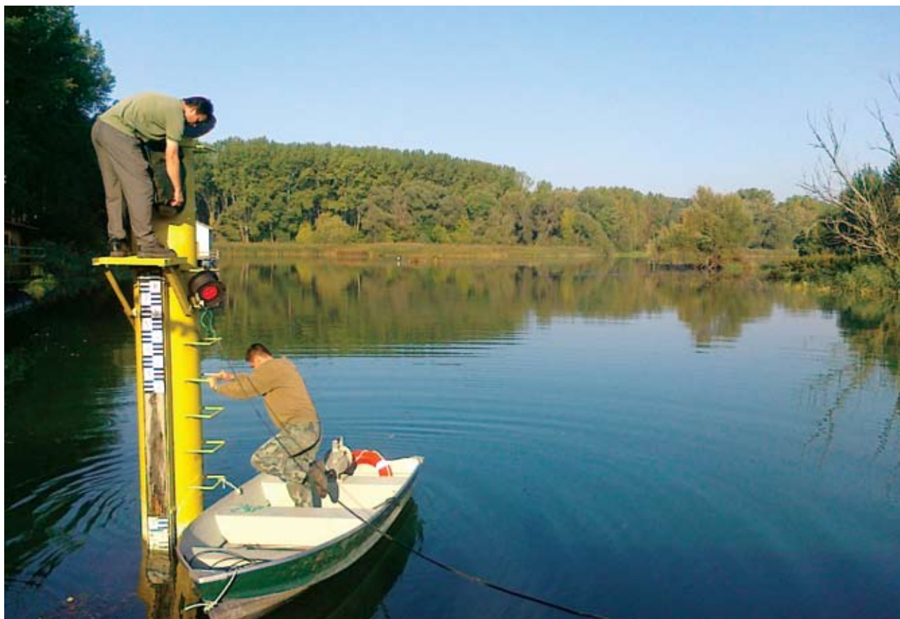
Odčítavanie údajov a čistenie limnigrafov v ramennej sústave Dunaja
