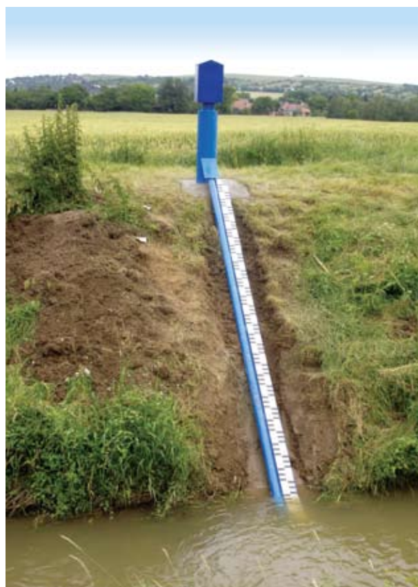
Nová limnigrafická stanica na vodnom toku Chvojnica v Trnoveci zabezpečí automatizovaný prenos vodného stavu priamo do dispečingu v Malackách
