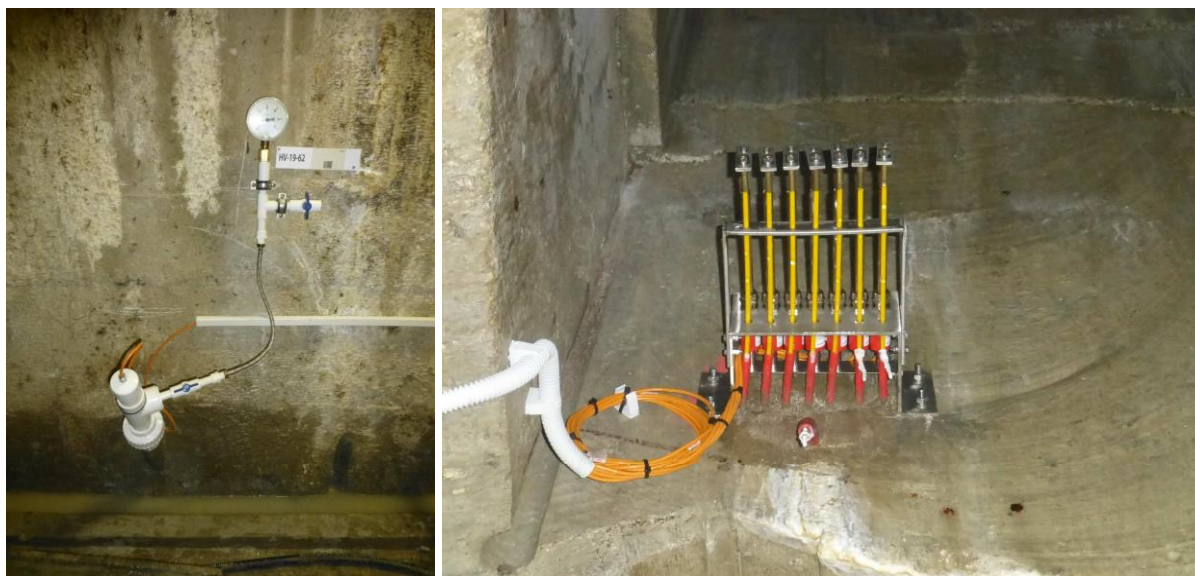
Obrázek 7: Nový tlakoměrný vrt a extenzometr
