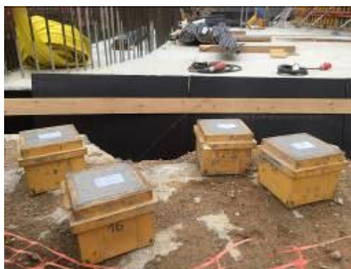
foto. 24 a foto 25: bourání přelivné plochy – patrný původní tvar na zbytku pravé stěny a odběry vzorků při betonážích
