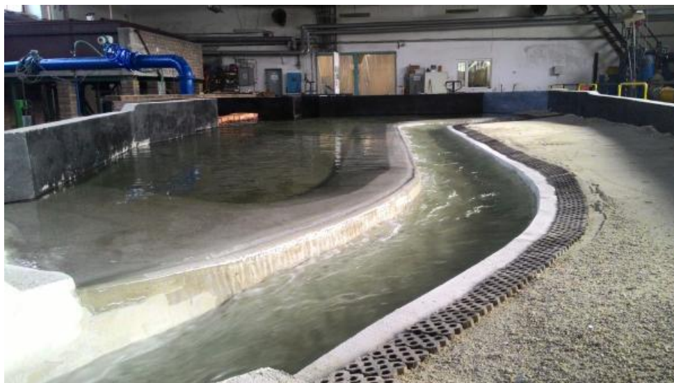
Obr.4: Priebeh merania na fyzikálnom modeli pri maximálnom prietoku.
