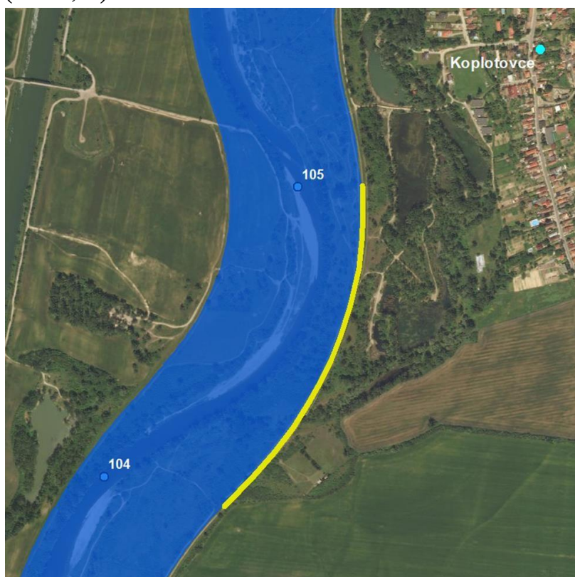
Obr.17 Dotyk modelovanej hladiny Q_{100} z korunou ochrannej hrádze – Koplotovce
