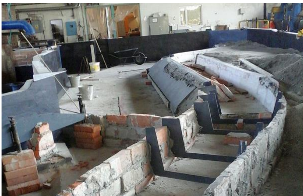
Obr.2: Výstavba fyzikálneho modelu bočného priepadu
