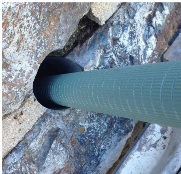
Obr. č. 5 – Kamerou zdokumentovaná porucha horninového masivu, jenž znemožňovala funkci vrtu – veškerá prosakující voda z puklin horninového masivu nekontrolovaně odtékala (foto vlevo nahoře).
