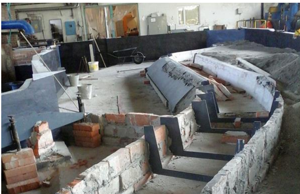
Obr.2: Výstavba fyzikálneho modelu bočného priepadu
