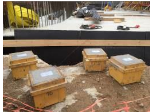
foto. 24 a foto 25: bourání přelivné plochy – patrný původní tvar na zbytku pravé stěny a odběry vzorků při betonážích
