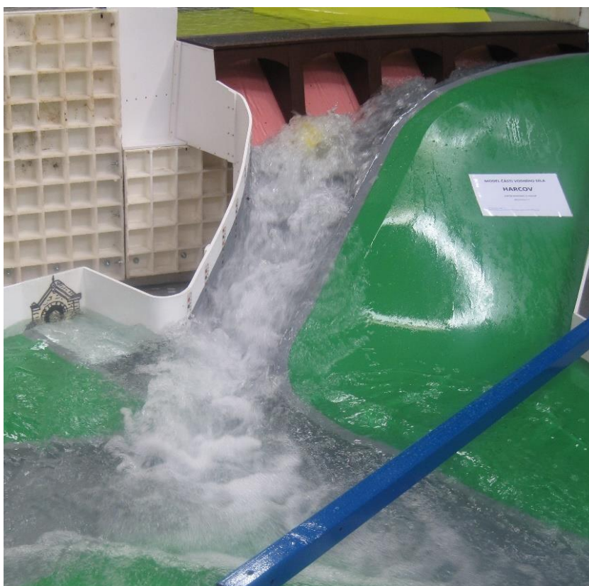
Obr. 3: Foto z měření hladin ve skluzu na VD Harcov
