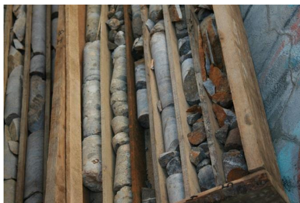
Obr.3: Jádrové vývrty v místě geologické
