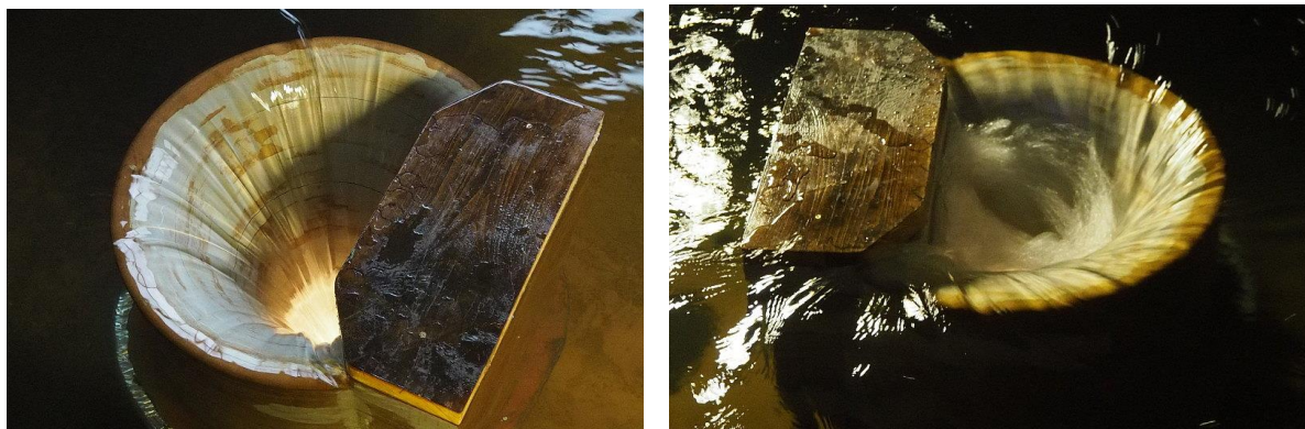
Obr.10 Prepad vody na modeli šachtového priepadu nezahľtený a zahľtený vtok
