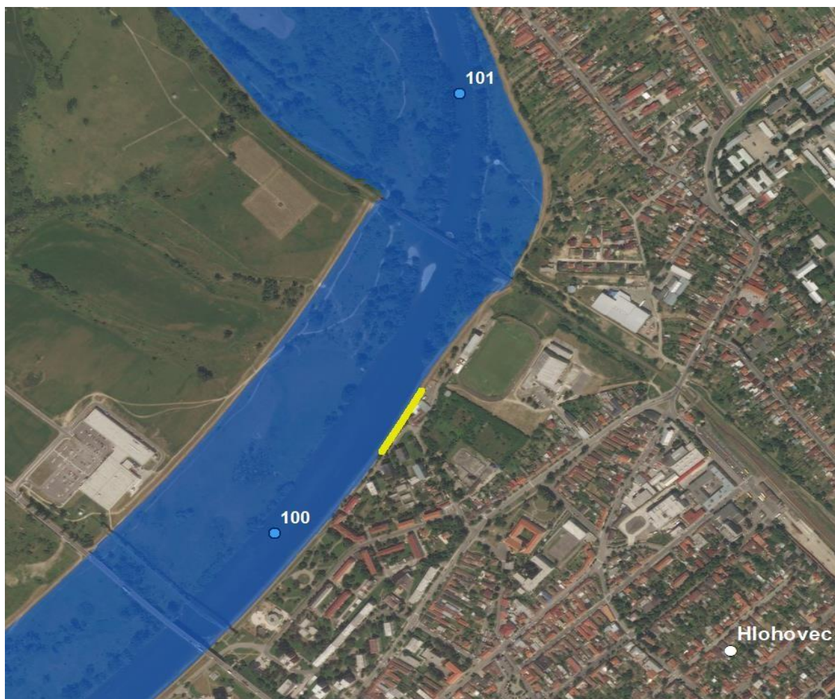
Obr.18 Dotyk modelovanej hladiny Q_{100} z korunou ochrannej hrádze – Hlohovec
