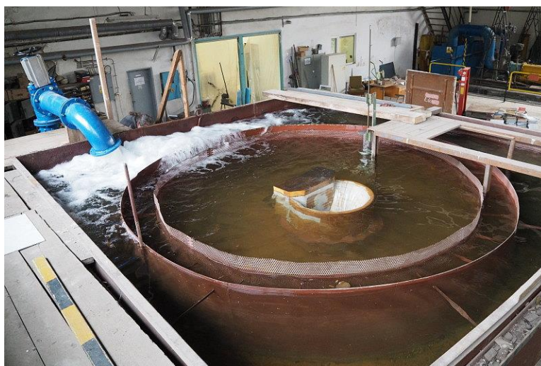
Obr.8 Modelový bazén so šachtovým priepadom VN Bukovec
