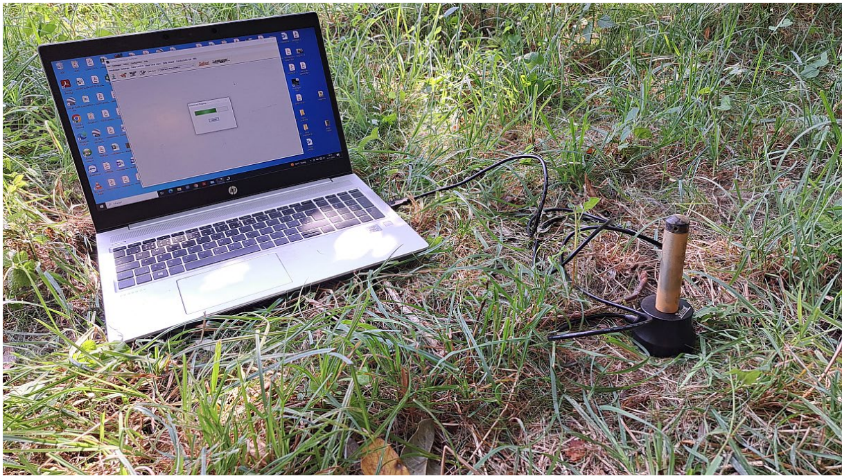
Sťahovanie údajov zo sondy na ďalšie spracovanie a vyhodnocovanie zaznamenaných dát.
