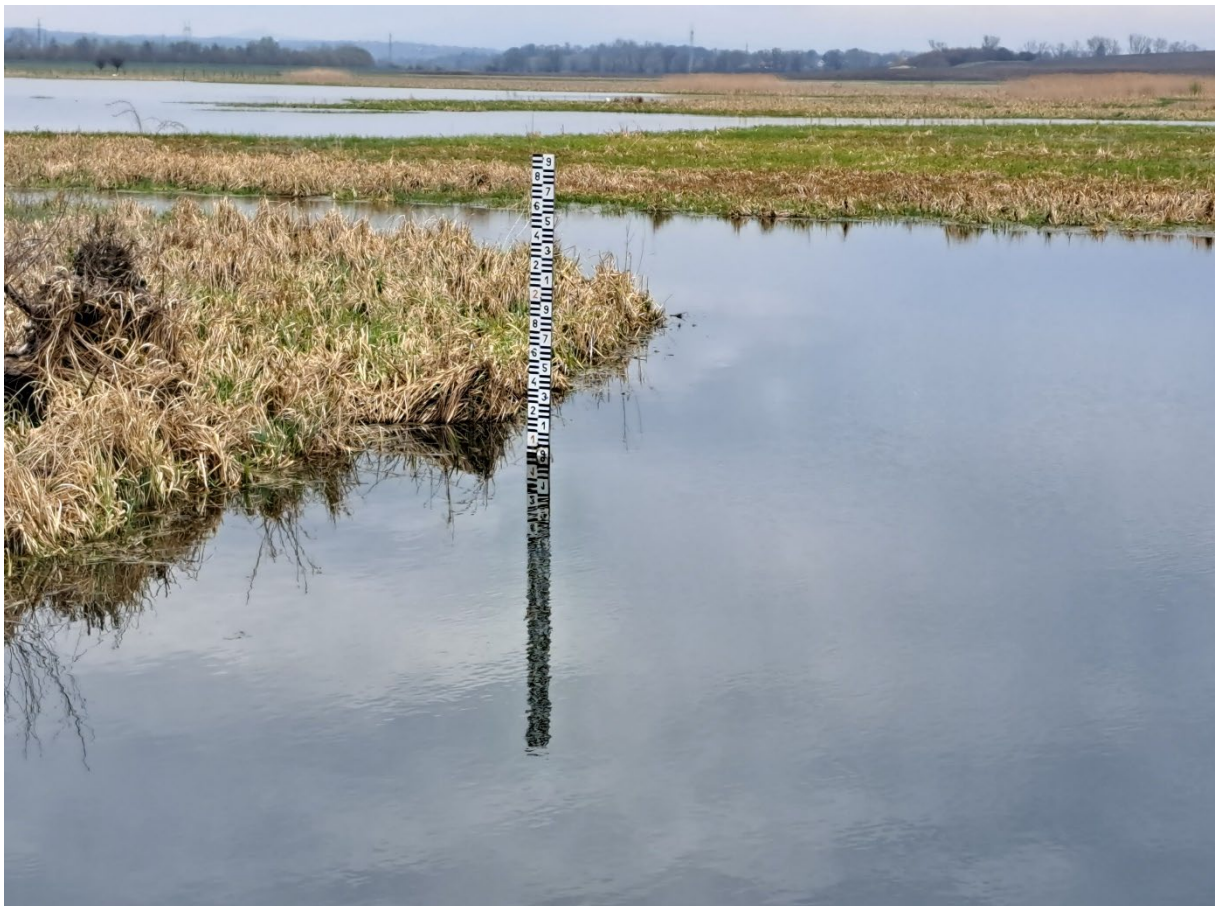
Vodomerná lata v PR Žitavský luh, zaznamenávanie hladín v starom koryte Žitavy v PR Žitavský luh nad výpustným objektom.
